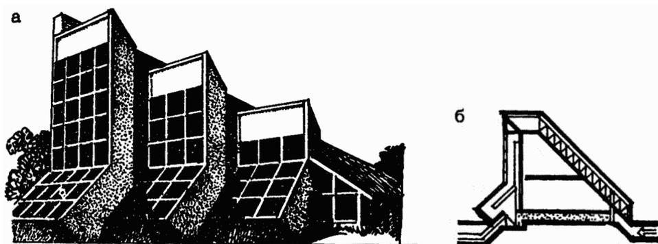
**Рис. 22. Солнечный дом в Техасе со стенами из глиноалюминиевых блоков:**
